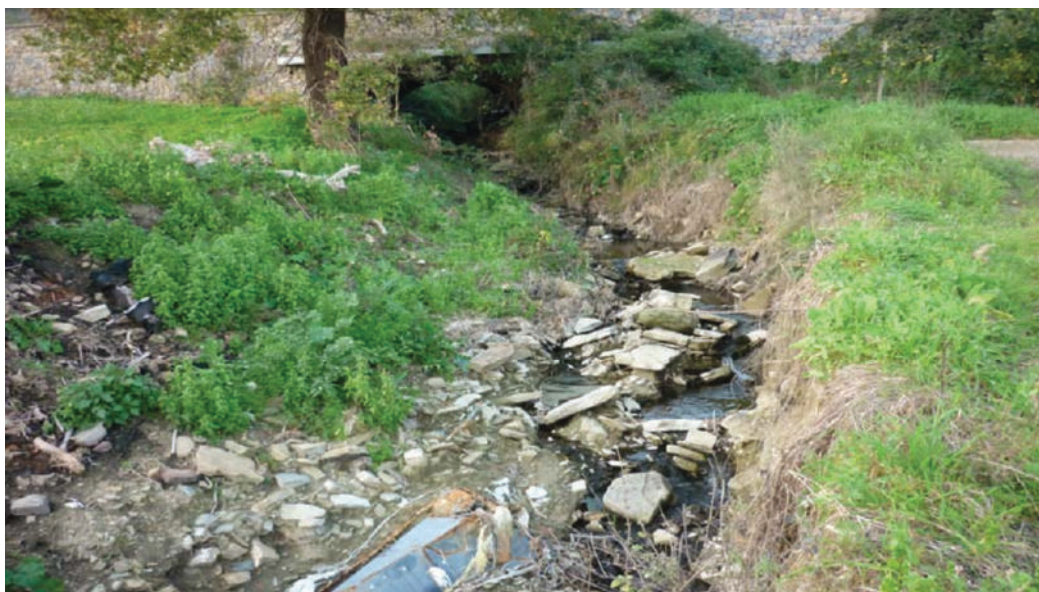
Foto4 – Corso d'acqua. Si osserva una scarsa attività erosiva sia lungo le sponde che sul fondo e modesto approfondimento dell'alveo, che non giustifica eventuali criticità legate a fenomeni di dissesto lungo le aree spondali.
