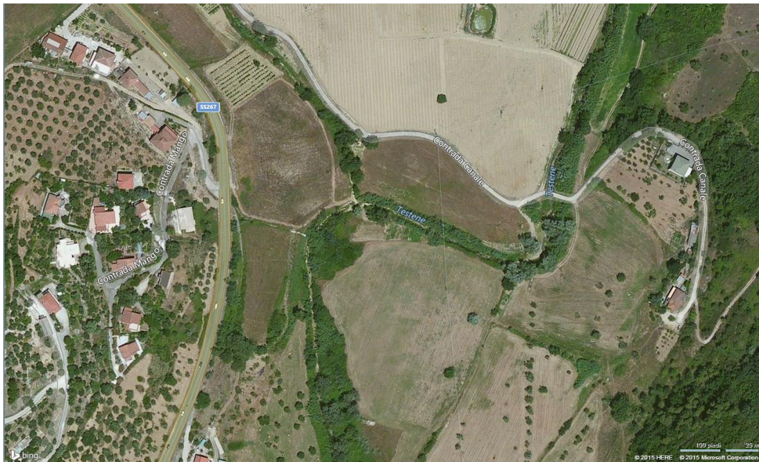
Figura 4: Meandro lungo il corso del fiume Testene. Si osserva una delle anse che si è avvicinata alla scarpata (lato sinistro), ove è presente la strada provinciale e numerose abitazioni
