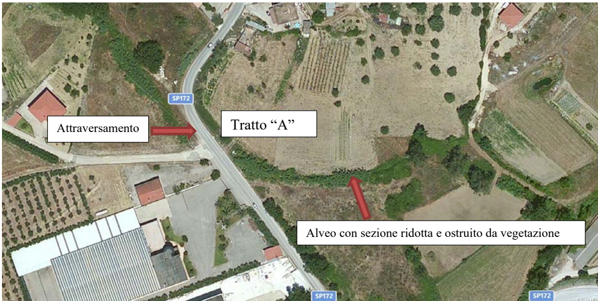
Fig. 3 – Particolare di uno dei punti di maggior criticità “attraversamento”
